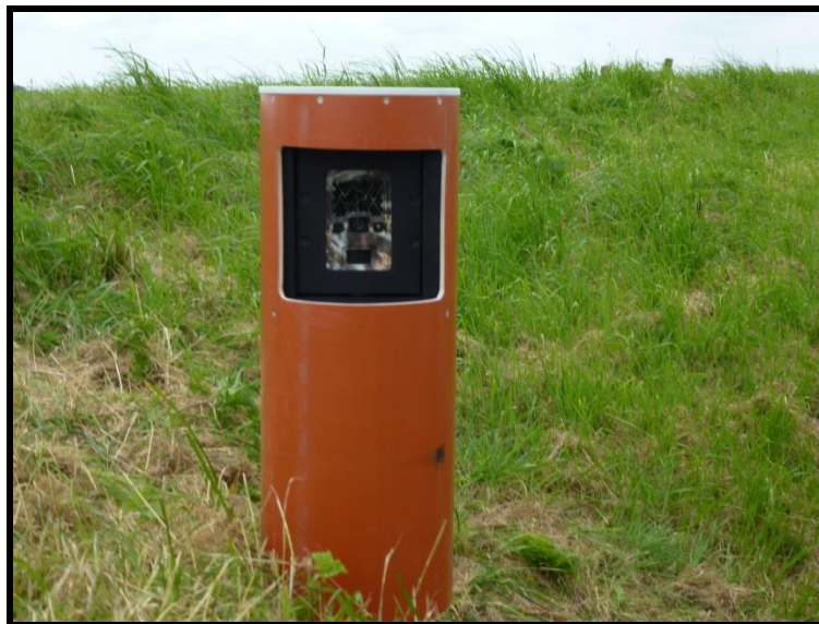
Abb. 14: Prototyp eines Kameragehäuses zum Schutz vor Witterungseinflüssen und Diebstahl.
